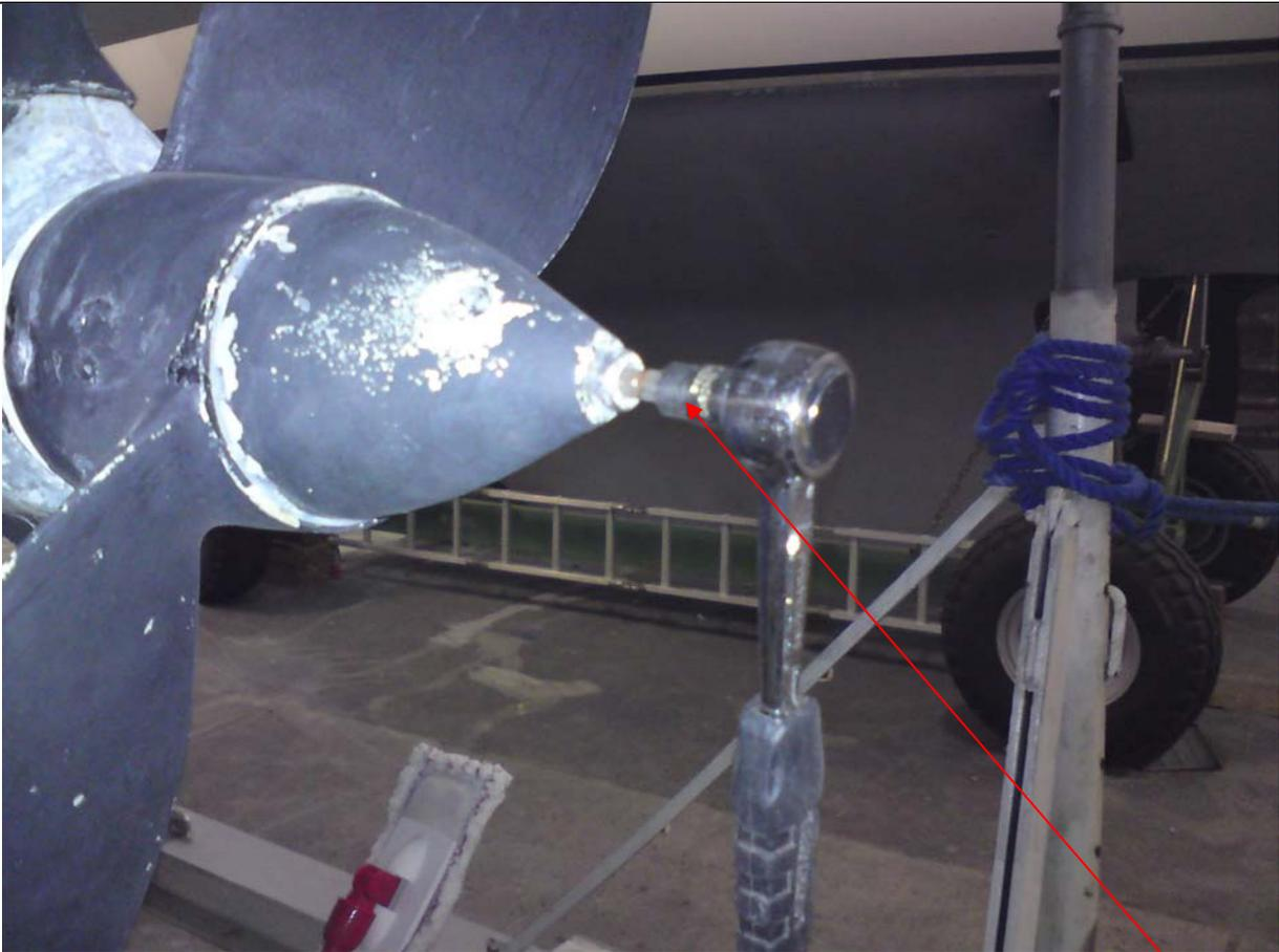
Als erstes wird der Propeller festgesetzt (Gang einlegen) und dann der Imbus-Bolzen herausgedreht (ganz normal links rum).
