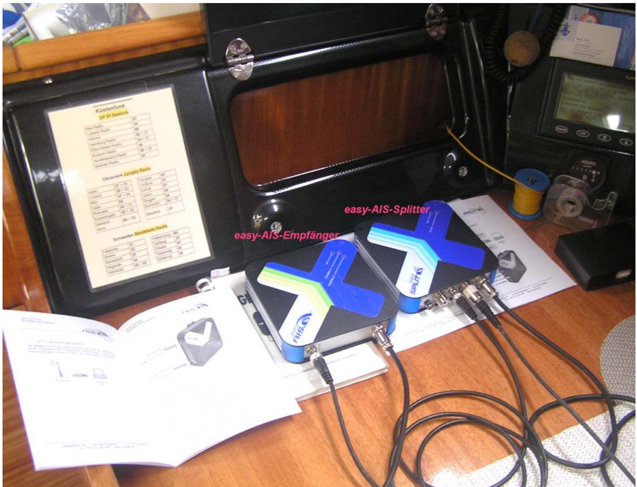
Der Splitter und der AIS-Empfänger finden hinter der Klappe des Navi ihren Platz.
