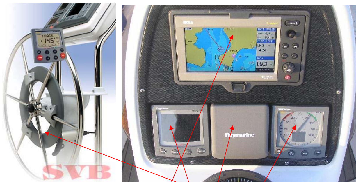
Autopilot „Herbert“ sowie Plotter, Echolot, Herbert, Windlupe
